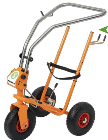
Le châssis Ripagreen® est construit en matériaux robustes et durables ; tube d'acier peint époxy pour la structure porteuse, tube et fil d'acier traité anti corrosion pour le timon de conduite et les équipements tels que le frein et le dispositif d'orientation de la buse. Il ne pèse cependant que 12,5 kg et se replie en quelques secondes pour optimiser le rangement.
