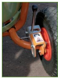
Un frein de parking permet de stabiliser le chariot lors d'opérations en pente.
